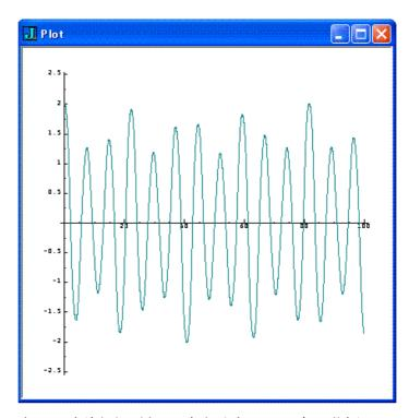
共振の場合 (w=5, q=5) には振幅がしだいに大きくなる。一方、共振していない場合 (w=5, q=4) には振幅は大きくなったり、小さくなったりする。
